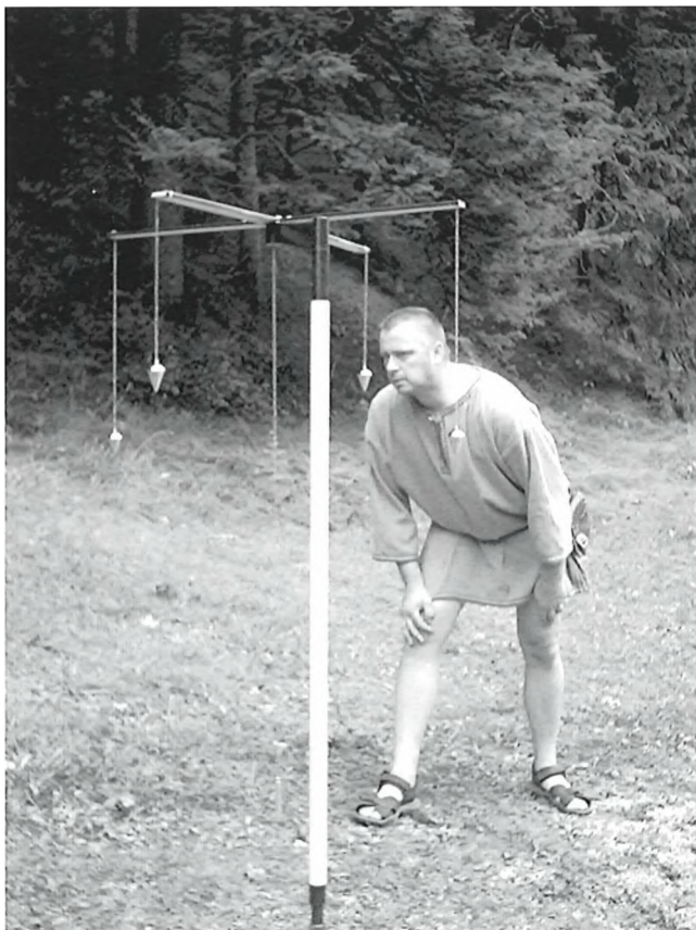
Abb. 5: Ein „römischer Vermesser“ mit Groma bei der Arbeit an der Originaltrasse der Via Claudia Augusta. Bei Windstille können die Fluchtpunkte exakt festgelegt werden.
