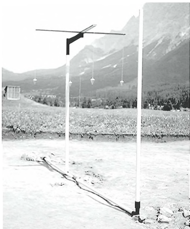
Abb. 9: Groma , Messlatte und Messstab bei den Ausgrabungen der römischen Handelsstation in Biberwier: Es liegt nahe, dass auch Fundamente für Gebäude mit diesen Geräten vermessen wurden.
