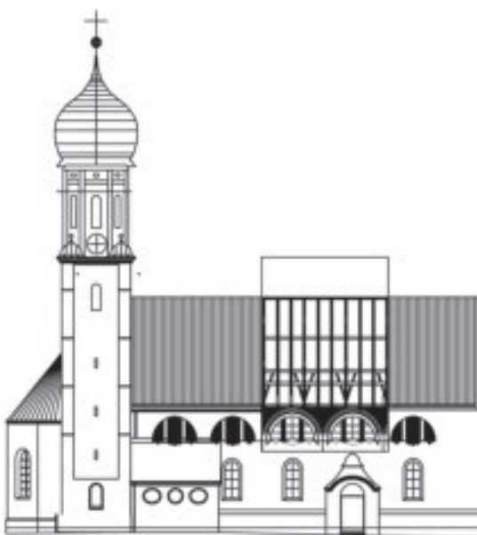
Abb. 4 St. Ulrich Eresing Nordansicht Anhebung der Traufe um ca. 2,75 m Lichtband aus fünf Rundbogen- Fenstern
