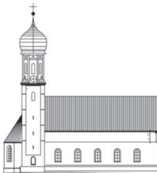
Abb. 3 b Anhebung der Dachkonstruktion von Dominikus Zimmermann 1756–1757 (Traufe und First: ca. 2,75 m)
