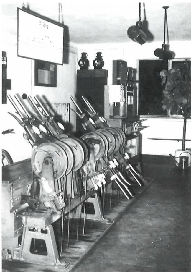
Das mechanische Stellwerk, Bauart „Einheit“, war ab 1936 in dem gemauerten Anbau am Empfangsgebäude untergebracht. Die Aufnahme stammt aus dem Jahr 1959.
